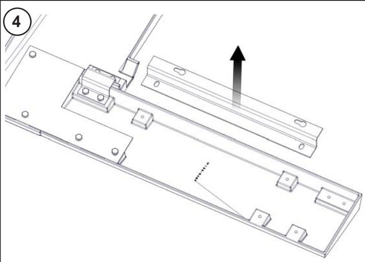
SLIDE THE SURROUND UP AND OFF THE SCREWS OF THE RETAINER.
